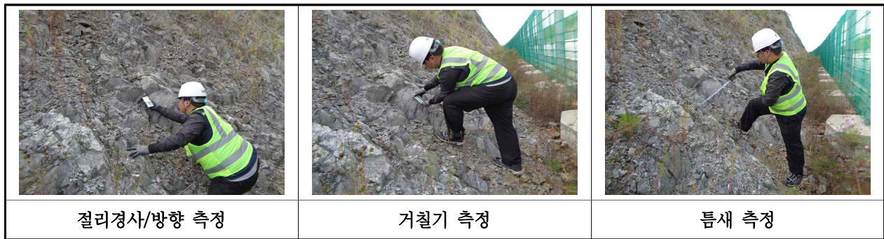
【그림 4.3.5】 불연속면 측정 현황
